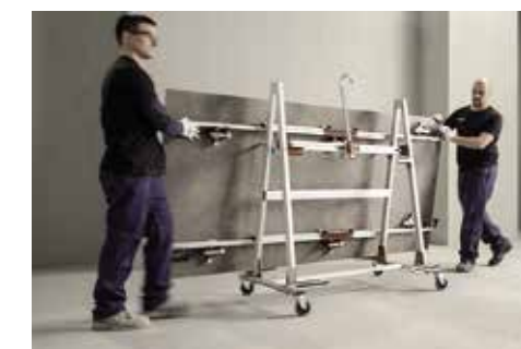
Per spostamenti in ampie superfici è anche possibile utilizzare un carrello per il trasporto delle lastre.
